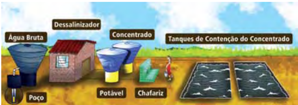
Figura 19 Ilustração do sistema simples do Programa Água Doce
