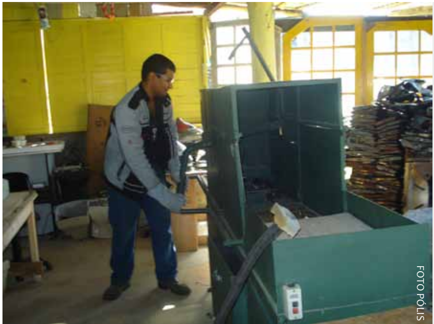
Figura 10 Máquina da Associação MetaReciclagem descontaminadora de tubos de imagem para uso de catadores
