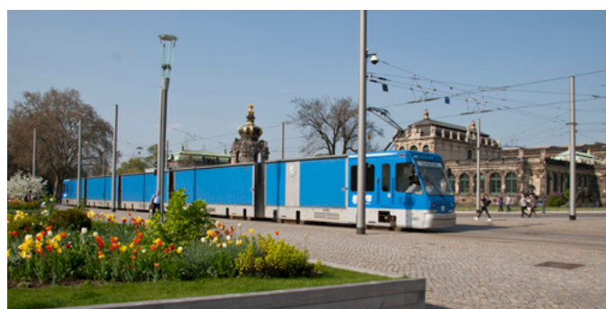
Figura 57: A viagem de um bonde de carga em Dresden substitui três viagens de caminhão no centro da cidade, Dresden. © DVB AG, 2011
